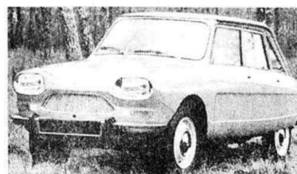
CITROËN AMI 8 CONFORT Motor: 2-sylindret, luftkjolet, 602 ccm. HK: SAE 35, DIN 32, ved 5750 omdr./min. Forhjulsdraft, 4-dørs. Registrert for 4 personer. Lengde: 3,99 m, bredde: 1,52 m, bagasjerom: 330 liter, vekt, kjøreklar 725 kg. Toppfart: 123 km/t. Pris fra kr. 24 400.
