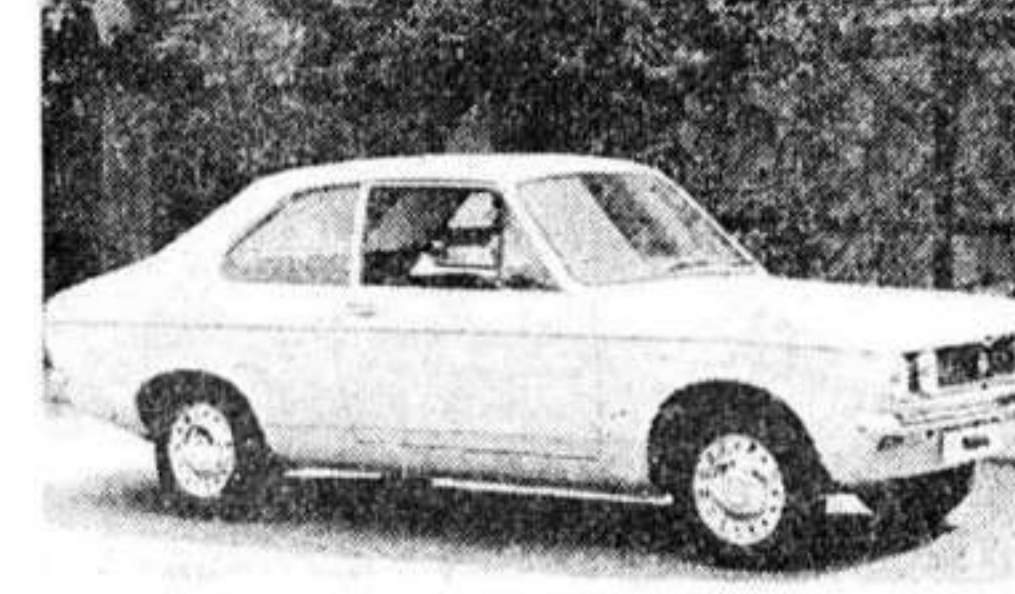
SUNBEAM 1500 DE LUXE Motor: 4-sylindret, vannkjolet, 1498 ccm. HK: DIN 63, ved 5000 omdr./min. Bakhjulsdrift, 2 + 4-dørs. Registrert for 5 personer. Lengde: 4,10 m, bredde: 1,59 m, bagasjerom: 538 liter, vekt, kjøreklar 830 kg. Akselerasjon: 0-80 ikke oppgitt, 0-100 16,1 sek. Toppfart: 140 km/t. Pris fra kr. 27 350.
