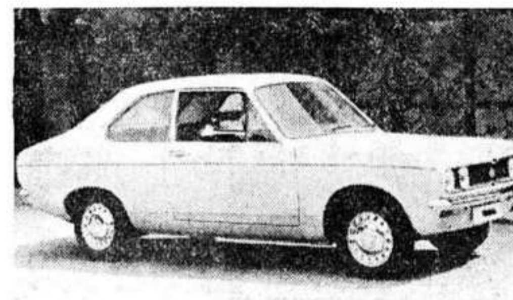
SUNBEAM 1250 Motor: 4-sylindret, vannkjolet, 1248 ccm. HK: DIN 53, ved 5000 omdr./min. Bakhjulsdrift, 3-dørs. Registrert for 5 personer. Lengde: 4,10 m, bredde: 1,59 m, bagasjerom: 538 liter, vekt, kjøreklar 830 kg. Akselerasjon: 0-80 ikke oppgitt, 0-100 19,2 sek. Toppfart: 130 km/t. Pris fra kr. 25 350.
