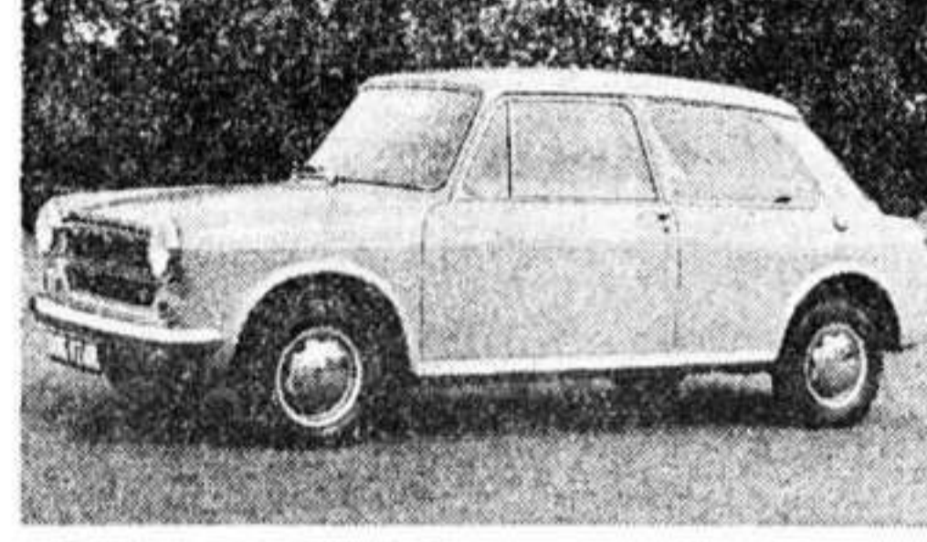
AUSTIN 1300 MK 3 Evt. varianter: 1300 GT MK 3. Motor: 4-sylindret, vannkjolet, 1275 ccm. HK: SAE 63, ved 5250 omdr./min. Forhjulsdraft, 2 + 4-dørs. Registrert for 5 personer. Lengde: 3,73 m, bredde: 1,53 m, bagasjerom: 200 liter, vekt, kjøreklar 840 kg. Akselerasjon: 0-80 12,1 sek., 0-100 17,5 sek. Toppfart: 140 km/t. Pris fra kr. 27 250.
