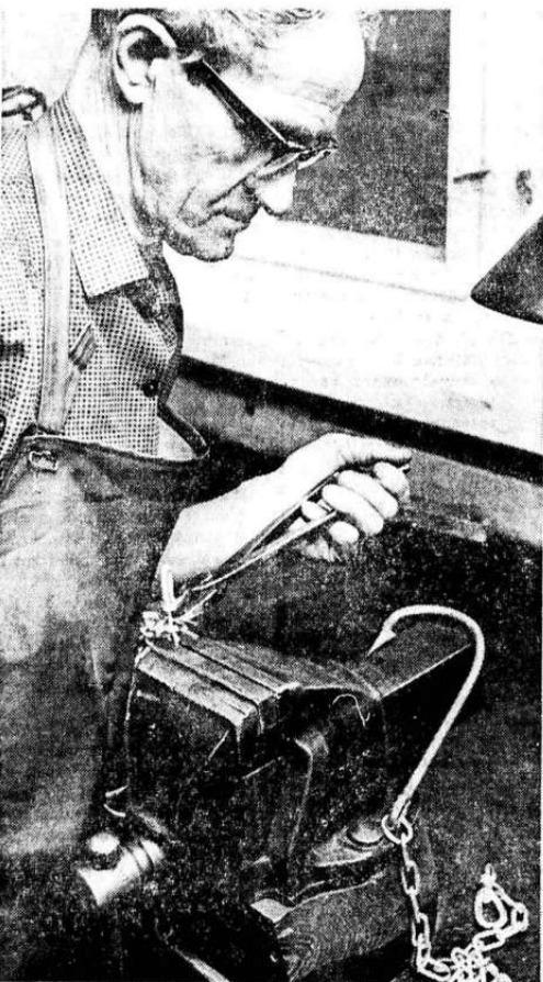
Enkelte detaljer i fiskekrok-produksjonen på Gjøvik er fremdeles håndverk. Her er Nils Olsen i ferd med å montere fortlommen — en solid kjetting med tilsvarende hvitvel, til den største av hakrokene.
